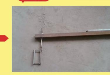
窑炉出砖平台和干燥出砖台前挡板的架空电眼架是直接焊在平台方管上的，都是由现场施工时焊接的。
